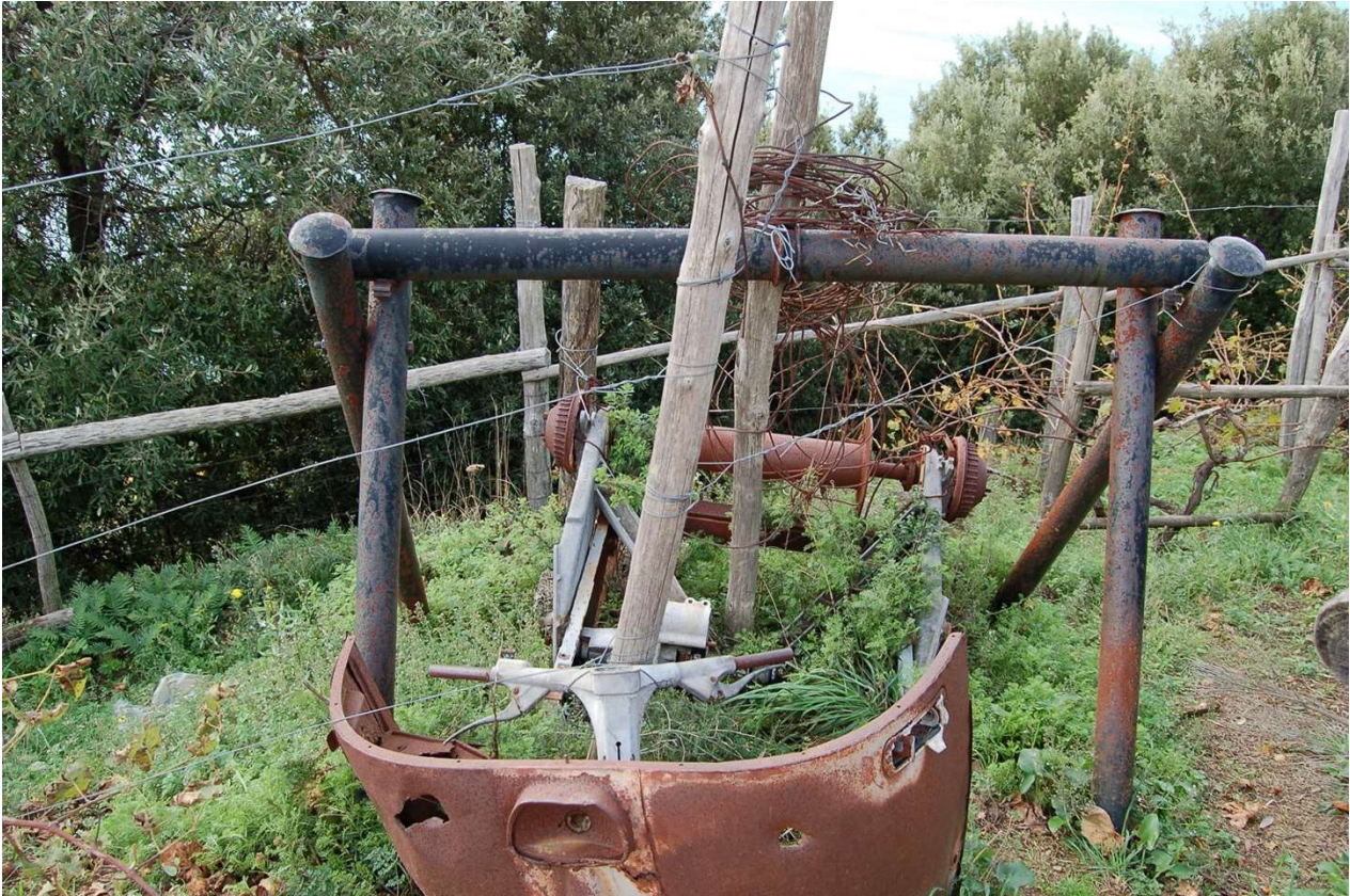
Motore di una teleferica in uso fino ad anni novanta ricavato da un motocarro
