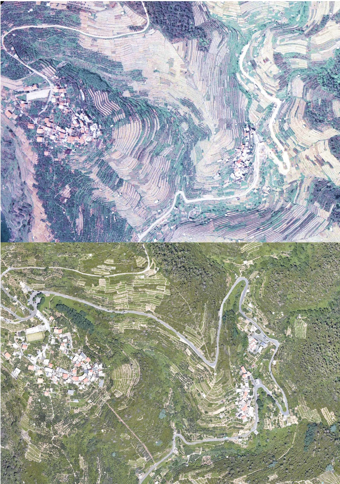
Fig. 4 – La costruzione della Strada provinciale 370 Litoranea delle Cinque Terre tra Groppo e Volastra, dopo il 1973 (sopra) in cui si vede il tratto precedente in cantiere. Sotto, la situazione attuale.
